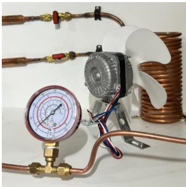
Figura 15 - Medidor de Alta Pressão Instalado Fonte: Autoria Própria
