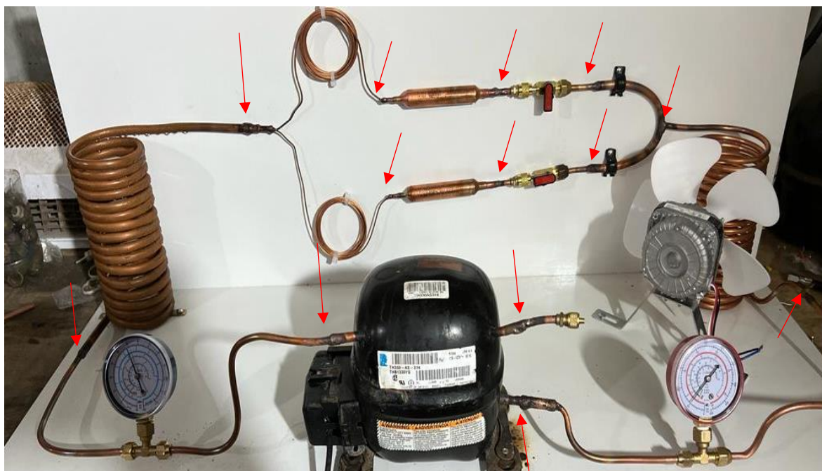
Figura 19 - Pontos de Soldas Realizadas Fonte: Autoria Própria
