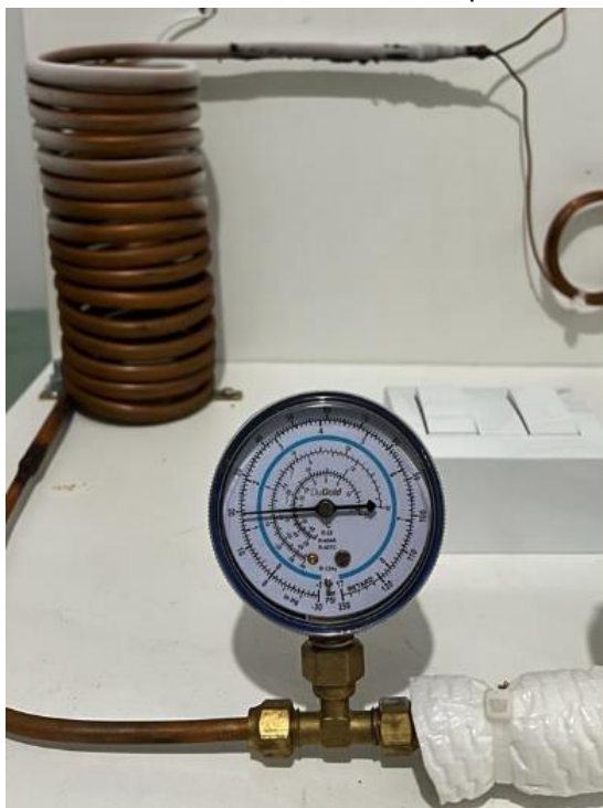
Figura 16 - Medidor de Baixa Pressão Instalado Fonte: Autoria Própria
