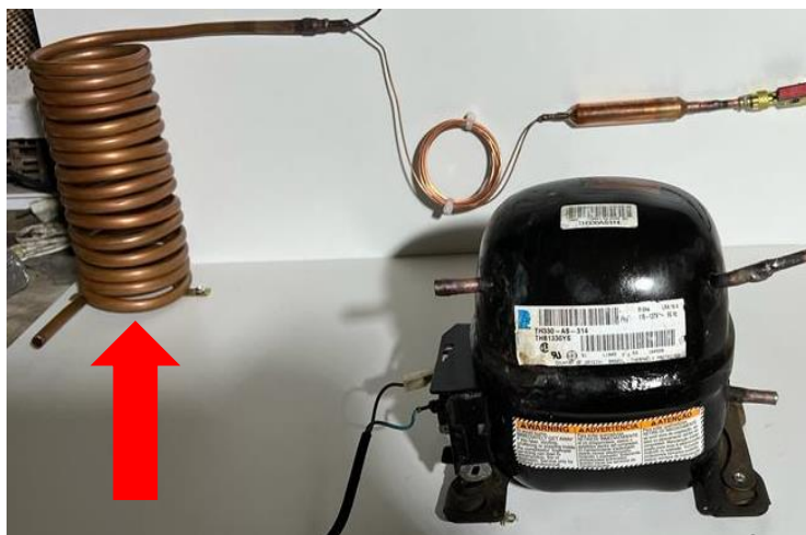
Figura 11 - Evaporador Instalado Fonte: Autoria Própria
