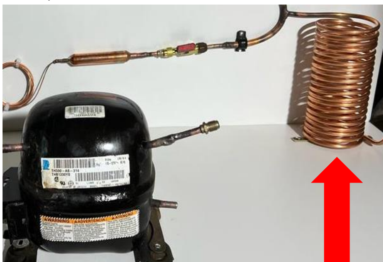
Figura 10 - Condensador Instalado Fonte: Aatoria Própria
