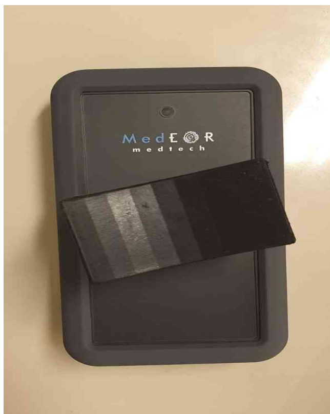
FIGURA 2: Dinamômetro e algômetro digital da marca Medeor MedTech utilizado para a mensuração da força isométrica.
